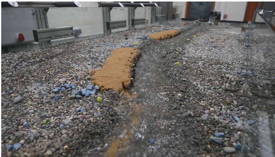
Figure 16. Canal hydraulique expérimental pour documenter les processus d'endommagement du génie végétal.
